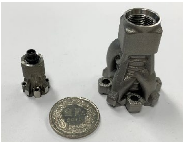
Additiver Ventilkörper in NG 1,5 und NG 3
