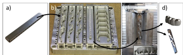
Additive Fertigung auf universellen Blechstreifen
