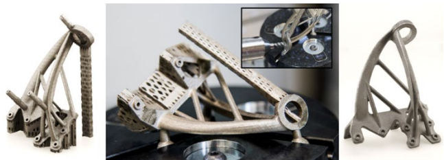
Integrierte Bolzen als universelle Schnittstelle für Spannsysteme
