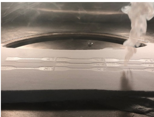
Rauchbildung beim Laser-Sintern von TPU
