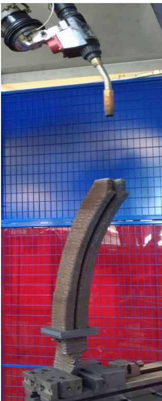
Mittels CMT-WAAM-Verfahren hergestellte Demonstrationsbauteile
